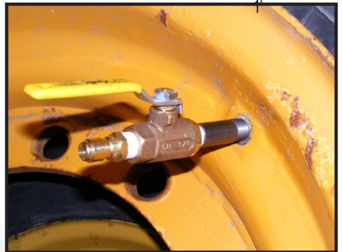
将球型气门嘴接头拧入气门嘴口径。打开、关闭球型气门手柄用来检查间距是否合适。
