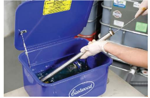
15) 用刷子清洗混合管。将混合管放入溶剂中。
