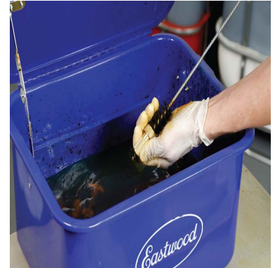
18) 清洗枪头连接阀（黄铜部件），并使其浸泡于清洗液内。
