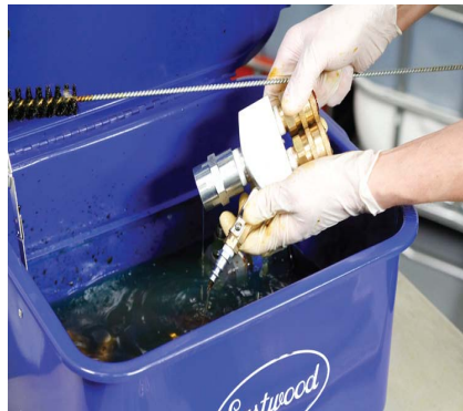
17) 打开手动操作杆主开关处的连接阀门（带压力表处的部件），清洗连接处部件，并使其浸泡于清洗液内。
