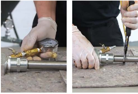
10) 将压力表和混合管从歧管头断开将连接器连接在头上。
