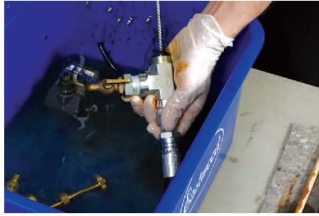
14) 将鞭子软管放在溶剂中，并用刷子清洁样品排放阀。确保样品排放阀打开。
