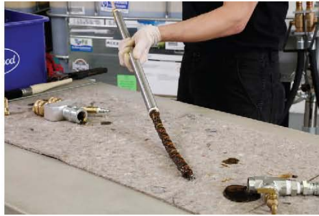
11) 用推棒从管中推出混合元件。
